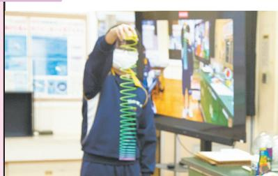
伸縮するばねのおもちゃ「レインボースプリング」を伸ばした状態で落下させるとどのようなようになるのかを撮影。スロー再生したところ、上部のばねが下に収納されてから落下していくことを確認。どういう力が働いているのかを推測しました。
