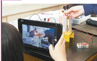
食塩水の入った機器に電流を流し電気分解を実施。陰極に発生した物質に火を近づける様子を撮影・スロー再生することで、爆発の様子が鮮明に映し出されました。音がするだけで何が起きているのかが分かりにくい瞬間的な現象も確認できました。
