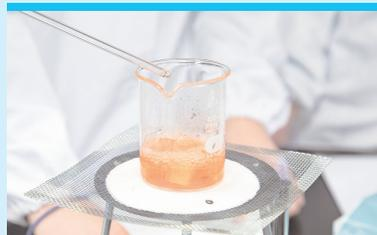
用意するのは、綿・毛・絹・レーヨン・ナイロン・ポリエステル製の6種類の布と4種類の合成染料。染料に白い布を浸して沸騰させ、水洗いして染色の程度を調べます。
